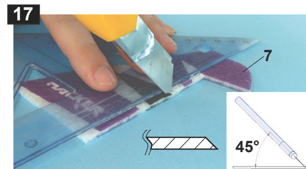
17 Ostrým nožem zařízněte hranu směrovky pod úhlem 45° dle obrázku. Using sharp knife provided with a new blade, make a 45° angle on the rudder at intrados side. Use a ruler for respected a right line.
